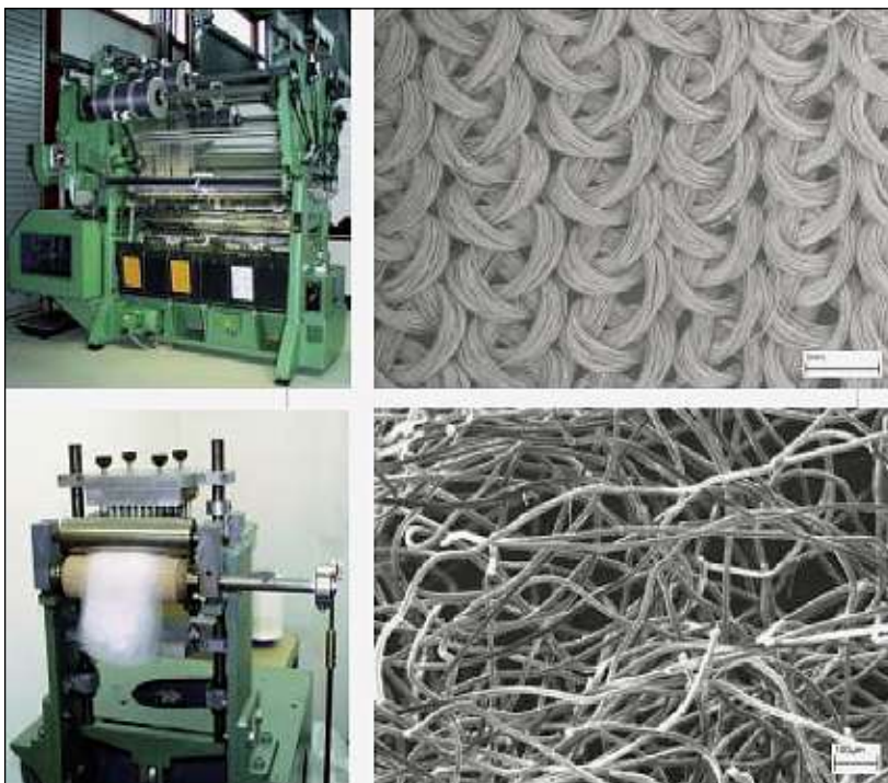
Abb. 1: Auf der linken Seite sind die beiden Textilmaschinen abgebildet, mit denen Gewirke (oben) und Vliese (unten) gefertigt werden. Auf der rechten Seite sieht man elektronenmikroskopische Aufnahmen der Gewirke (oben) und der Vliese (unten).
