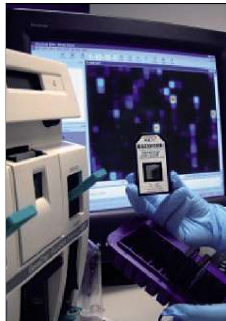
Abb. 4: Exemplarische Darstellung eines Affymetrix DNA-Chips (Vordergrund). Weiterhin zu sehen ist eine Affymetrix Hybridisier- und Waschstation (links im Bild). Im Hintergrund ist ein Ausschnitt nach dem Scan des hybridisierten Affymetrix DNA-Chips auf dem Monitor dargestellt. Fotos: Smeets
